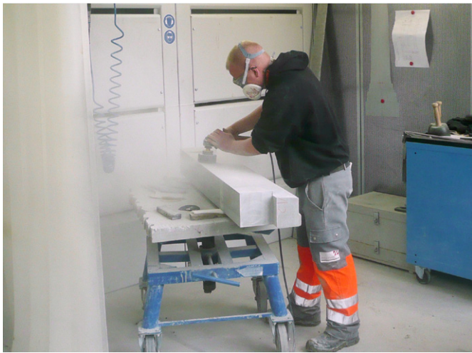
Der Schleifstaub muss wirkungsvoll abgesaugt werden.
