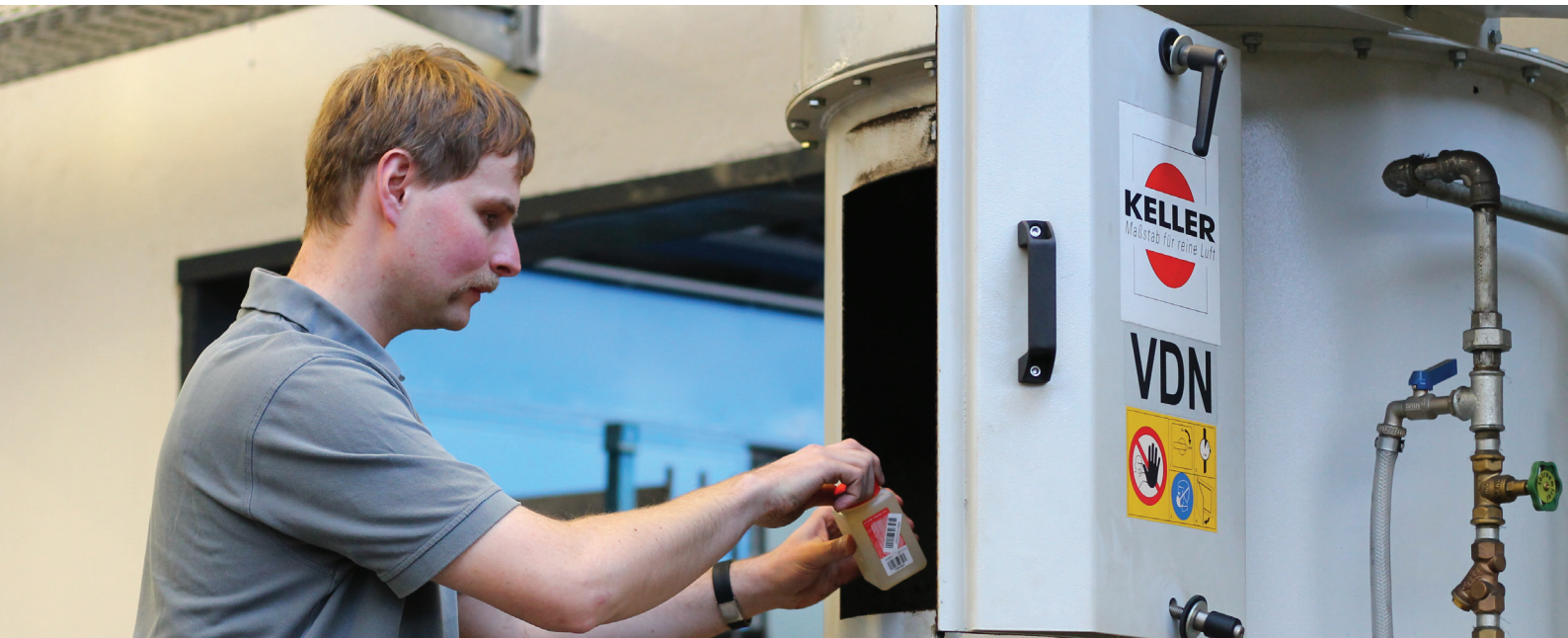
Prüfung der Wasser-Beschaffenheit eines Nassabscheiders
