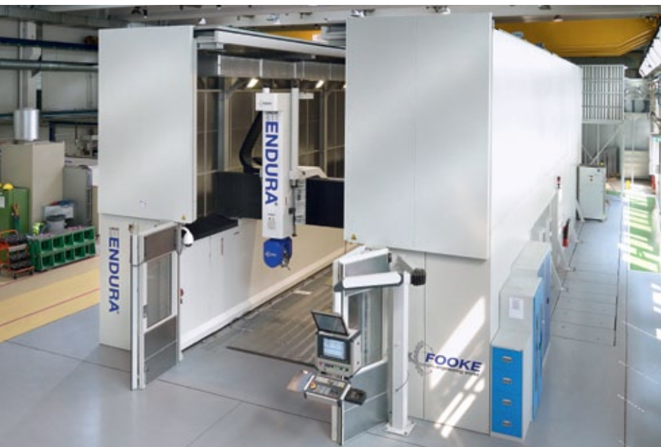
Die Erfassung der Stäube in der 14 Meter langen Portalfräsmaschine stellte eine Herausforderung dar
