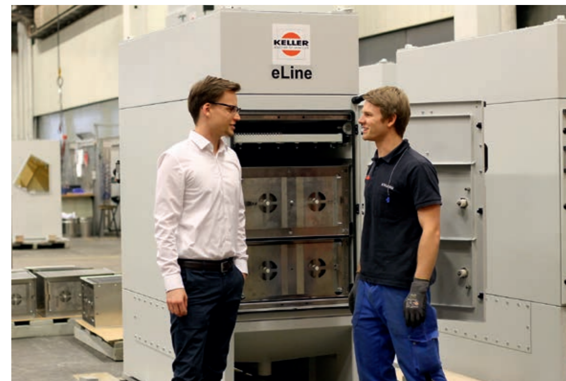
Keller-Projektingenieur Thomas Nägele (links) erläutert das Abscheideprinzip des eLine, welches darauf beruht, dass sich positiv geladene Teilchen und ebenso geladene Platten gegenseitig abstoßen
