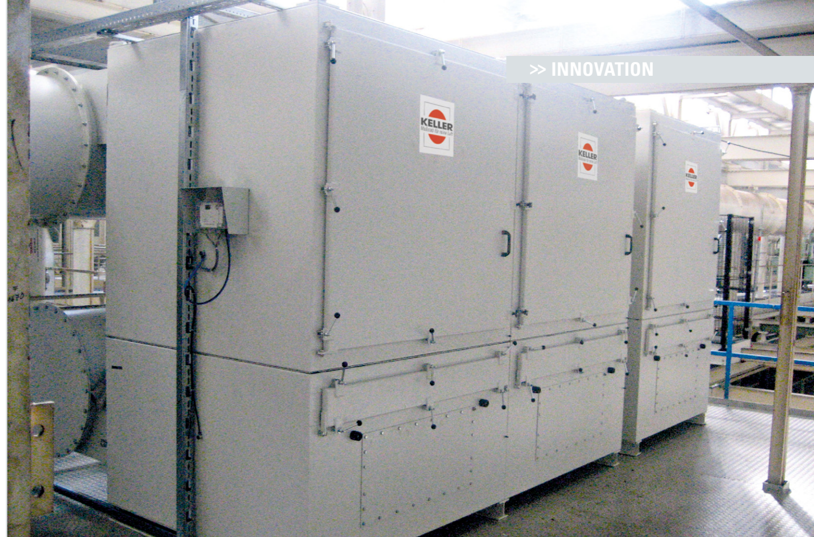
Der AERO scheidet Kühlschmierstoff-Aerosole, die beim Schleifen von KFZ-Werkstücken bei Daimler in Stuttgart entstehen, zuverlässig ab.
