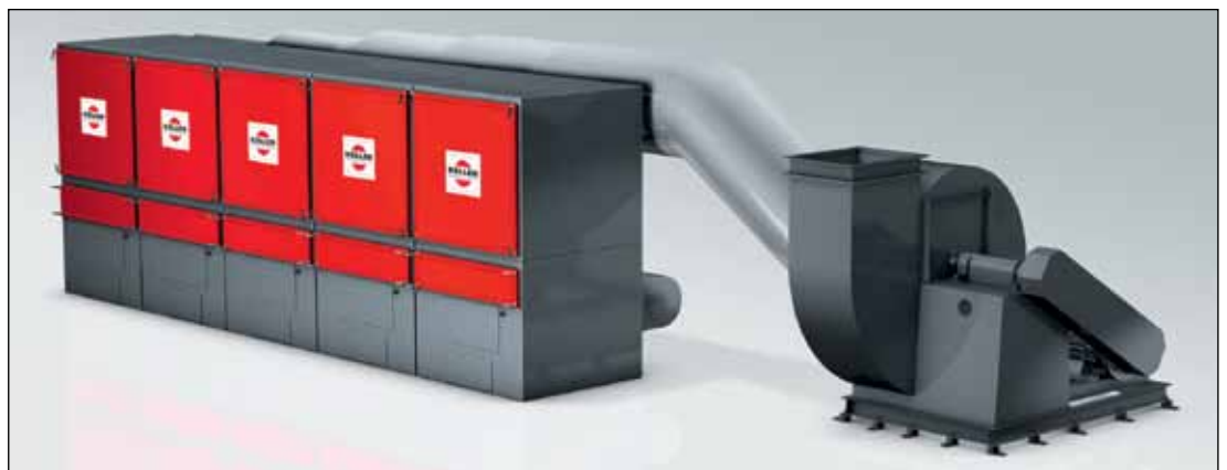
Zentrale Abscheidestation, bestehend aus fünf AERO®-Modulen der Baugröße 3 und einem Ventilator (Nennluftmenge 64 000 m 3 /h)
