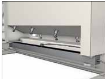
Wiegeeinrichtung am Dosierbunker zur Gewichtskontrolle des Füllstandes und der Feststellung der Mengenübergabe bzw. -abgabe
