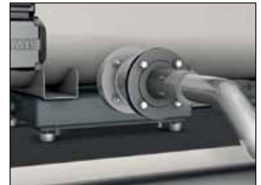
Wiegeeinrichtung der VARIO RECLAIM-Filtereinheit. Wird auch zur Feststellung des Sättigungsgrades des Precoatmaterials genutzt
