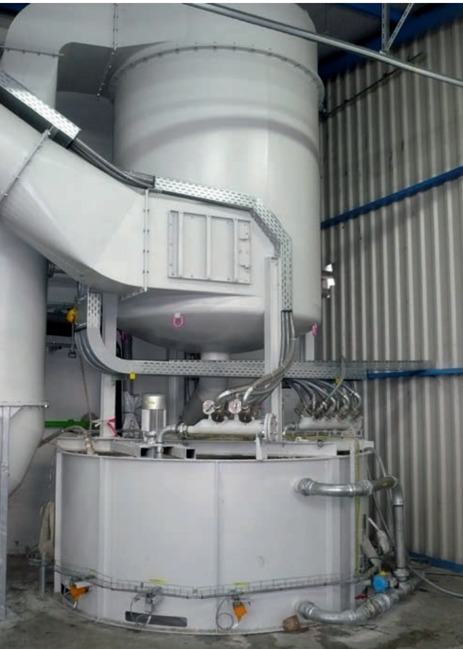
Die Venturi-Nassabscheideanlage regelt automatisch die Luftmenge der neun angeschlossenen Extruder entsprechend dem tatsächlichen Absaugbedarf nach. Das spart bis zu 30 Prozent Energie ein
