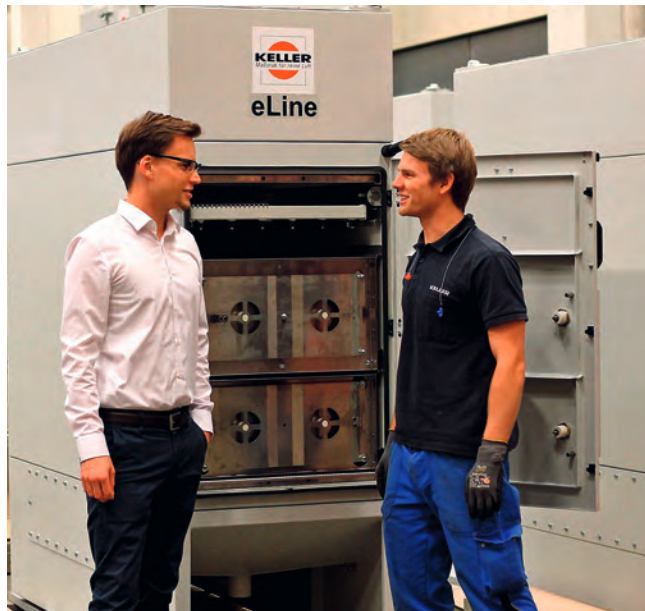
Keller-Projektingenieur Thomas Nägele (links) erläutert das Abscheideprinzip des eLine, das darauf beruht, dass sich positiv geladene Teilchen und ebenso geladene Platten gegenseitig abstoßen
