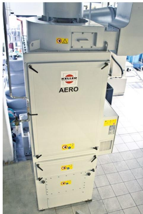
Drei Keller-Absauganlagen versorgen den Maschinenpark bei Emil Arnold. Eines der Geräte, der Ölnebelabscheider AERO, filtert auch kleinste Aerosole zu 99 Prozent aus der Luft.
