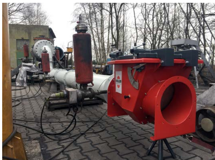
Abb. 2: Die verbesserte Rückschlagklappe ProFlapPlus mit noch dichter schließender Klappe sowie einer automatischen Verriegelung für den Ernstfall absolvierte die Prüfungen nach der neuen, strengeren Norm EN 16447.
